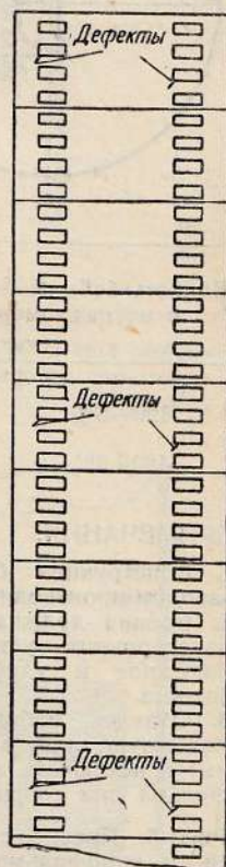
Рис. 2. Дефекты, полученные в результате наличия двух дефектных зубьев
