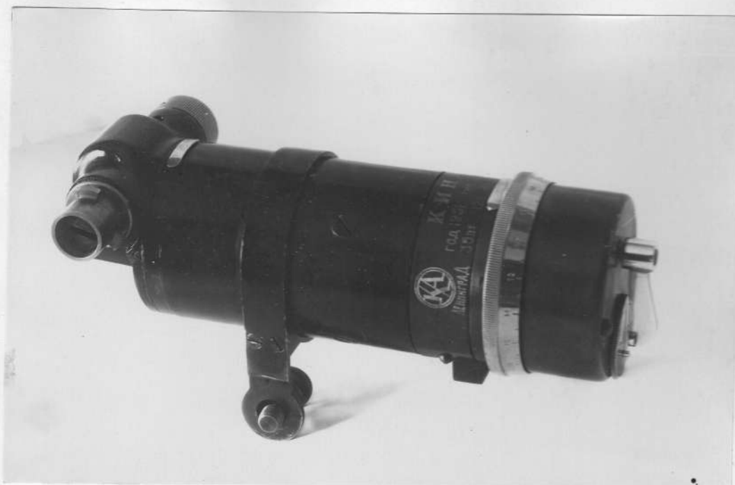
Фото 21. Электродвигатель постоянного тока 12 вольт 45 ватт.
