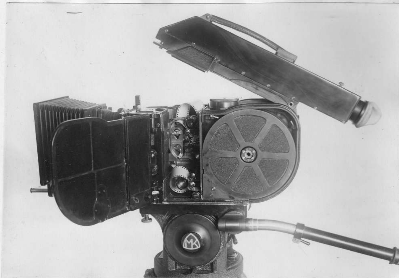
Фото 27. Переход пленки из второй плоскости в третью и в приемную кассету.
