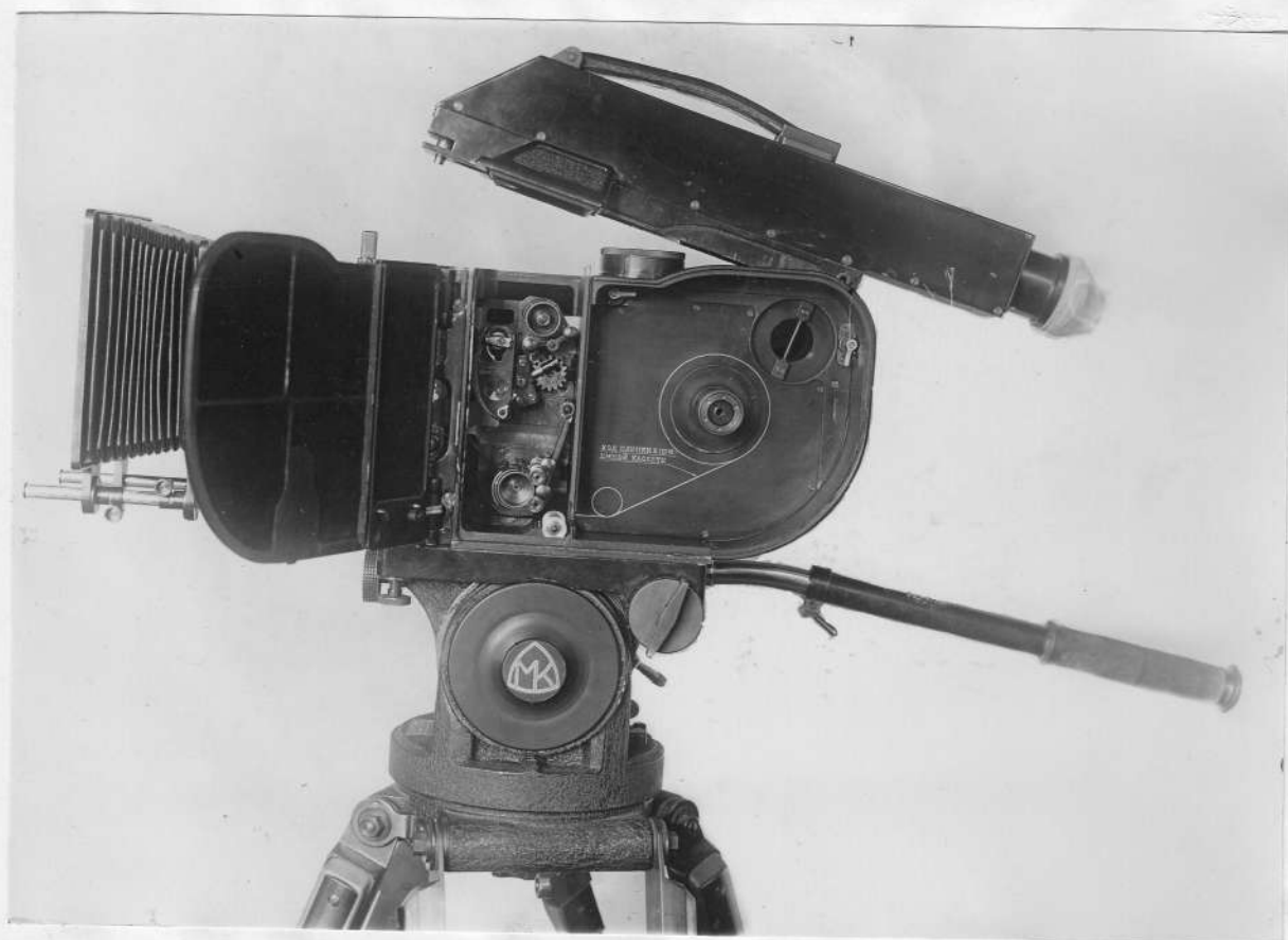
Фото 13. Положение фрикционов в аппарате для работы его с кассетами емкостью 120 метров пленки.
