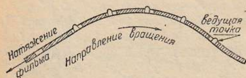
Рис. 3. Схема зацепления фильма со звуковым барабаном. Шаг перфорации меньше шага зубцов
