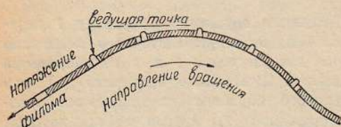
Рис. 4. Схема зацепления фильма со звуковым барабаном. Шаг перфорации больше шага зубцов
