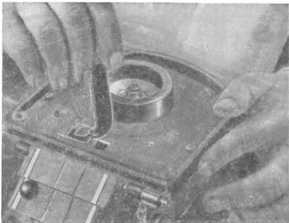
Рис. 9. Подгибание рамки грейфера ключом-вилкой
