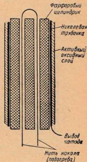
Рис. 5. Схематическое устройство подогревного катода
