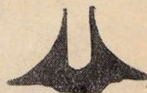
Рис. 4. Отгибание лопастей мальтийского креста от неправильного входа пальца
