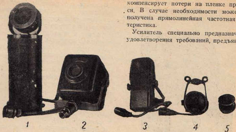
Рис. 4. Сравнительный вид микрофонов: 1 и 2—конденсаторные микрофоны; 3—ленточный микрофон RCA; 4—динамический микрофон RCA; 5—микрофон Вестерн-Электрик 630-А
