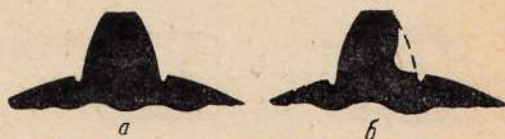
Рис. 6. Профиль зубьев барабана: а — исправный зуб; б — изношенный зуб
