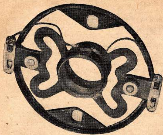
Рис. 3. Центрирующая шайба громкоговорителя ГДД-12, собранная с подвижной катушкой
