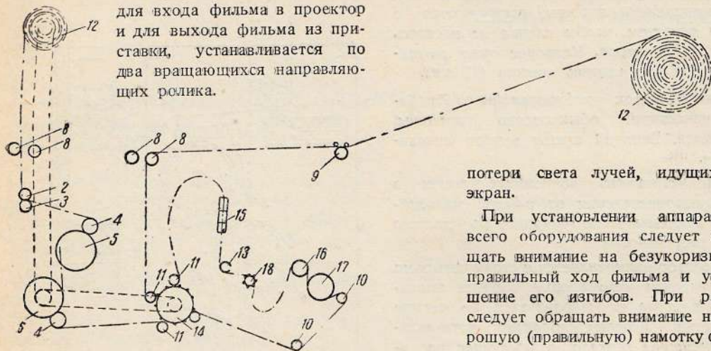
Рис. 3. Схема движения пленки в столе для контроля и ремонта фильмокопий: 2—прижимной ролик; 3—парафинирующий ролик; 4—прижимной ролик чистильного барабана; 5—чистильный барабан приставки; 6—чистильный барабан приставки; 8—направляющие ролики стола; 9—зубчатый барабан метромера; 10—направляющие ролики звуковой части проектора; 11—направляющие ролики комбинированного зубчатого барабана проектора; 12—фильм; 13—ролик выравненного кадра в проекторе; 14—комбинированный барабан проектора; 15—фильмовый канал проектора; 16—фрикционный ролик звуковой части проектора; 17—вращающийся трек звуковой части проектора; 18—скачковый барабан проектора
