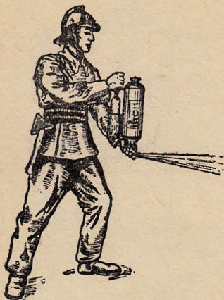
Рис. 8. Приведение в действие огнетушителя «Тайфун»
