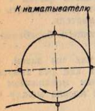
Рис. 19. Схема работы задерживающего барабана
