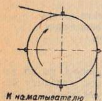
Рис. 17. Схема работы тянущего барабана
