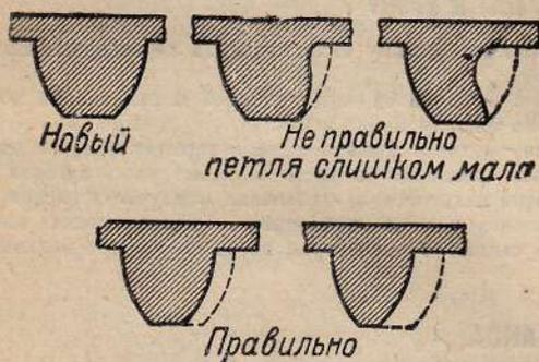
Рис. 5. Износ зубьев барабанов.
