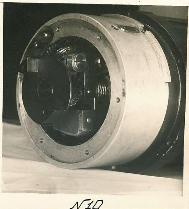
На передней крышке корпуса, в полости редуктора, соосно с валом ротора установлен полый червяк.
