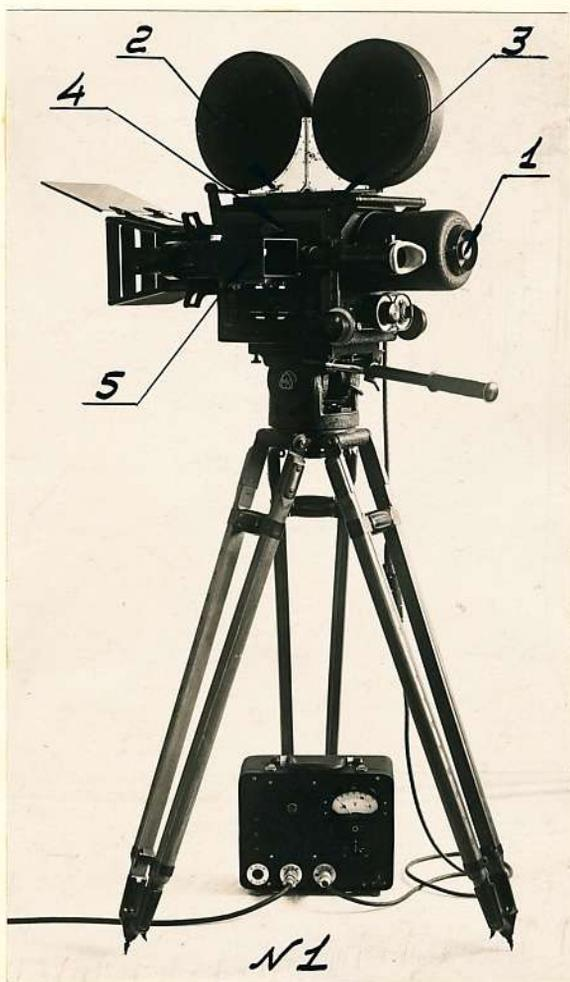
Аиносьемочный аппарат "Москва" оформлен в виде прямоугольного звукозаглушающего корпуса с приставными наружными кассетами, электродвигателем, душой, визиром, светозащитным устройством с фильтродержателем и блендой, коммутирующим и пусковым устройствами.
