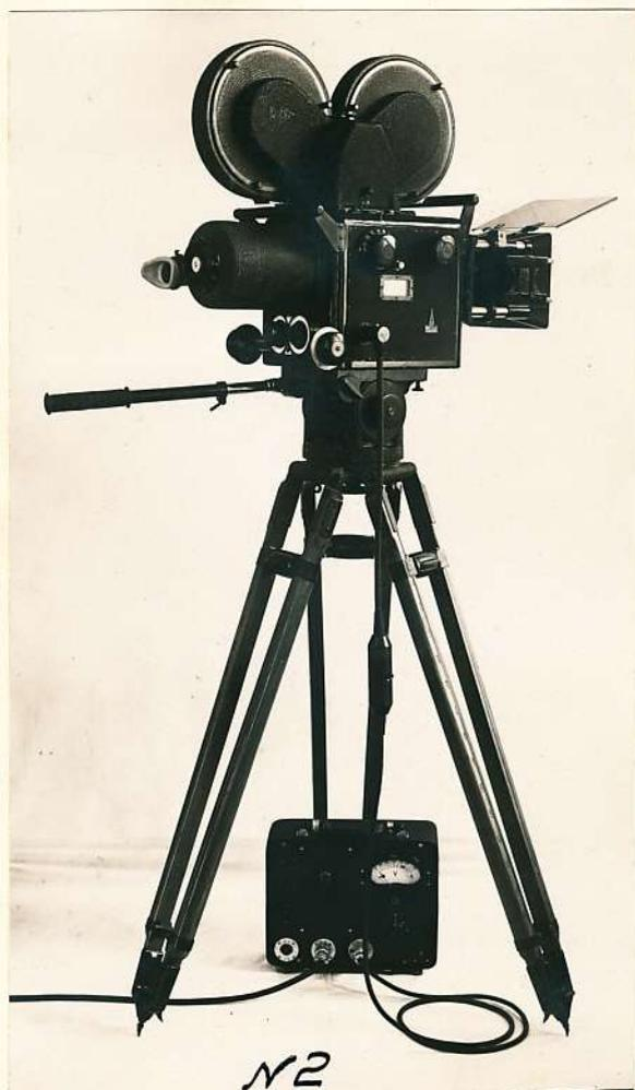
Внутри корпуса расположен весь механизм аппарата, включающий грейферный механизм, транспортирующий механизм, механизм обтюратора, фокусирования и диафрагмирования.
