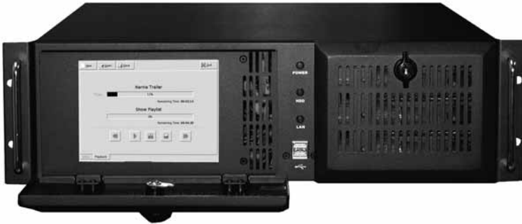
DCP2000 – автоматическая пятидисковая программа загрузки и воспроизведения; система touchscreen для воспроизведения защищена запираемой дверцей...
