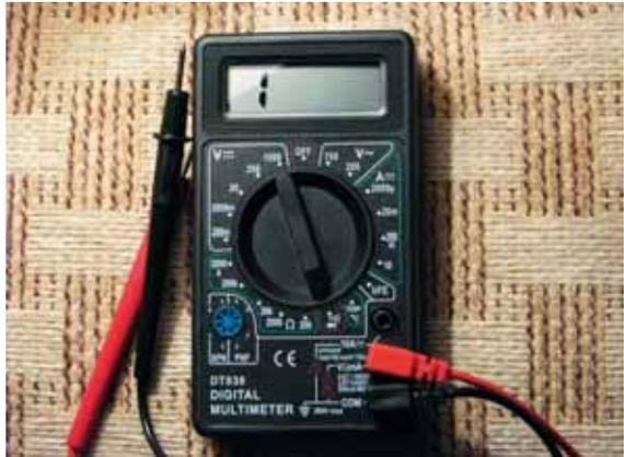
Рис. 1а. Цифровой мультиметр DT838 установленный в положение «диод»
