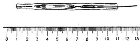
Рис. 20. Импульсная капиллярная кинопроекторная лампа мощностью 80 Вт
