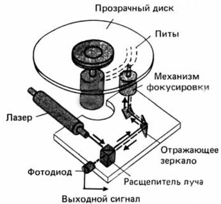
Рис. 2. Воспроизведение диска VLP: луч лазера (сплошная линия) отражается от внутренней поверхности подложки с питами, модулируется питом, изменяющими отражательную способность диска, и возвращается в микрообъектив. Его путь (штриховая линия) заканчивается в фотодиоде
