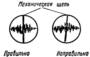
Рис. 5. Установка механической щели перпендикулярно базовому краю фильма
