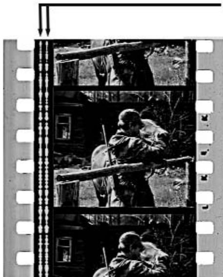
Рис.1. Двухдорожечная оптическая фонограмма.
