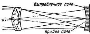
Рис. 12. Плоско-вогнутая «линза» для выправления поля изображения
