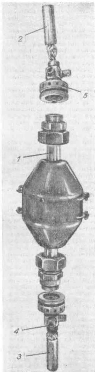
Рис. 4. Бесштуцерная лампа и специальные эластичные удлинители:
