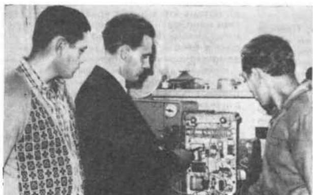
Б. Подлуский (в центре) проверяет отремонтированный усилитель 90У-2
