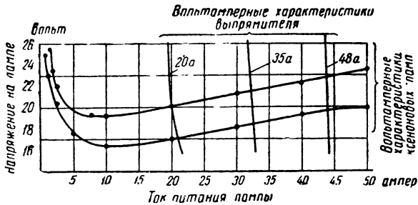
Рис. 4. Вольтамперные характеристики ксеноновых ламп и выпрямителя 45ВУК-50
