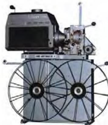
штангу с двумя держателями и муфтами для показа рекламных вставок при обратной перематке основного фильма. Эти проекторы поставляются только с длинным столом фонаря. Наиболее перспективная модель имеет встроенную систему обратной перематки на разных скоростях.
