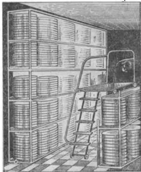
Рис. 5. Подвижная стремянка в боксе (верхняя часть правого стеллажа на рисунке не показана)
