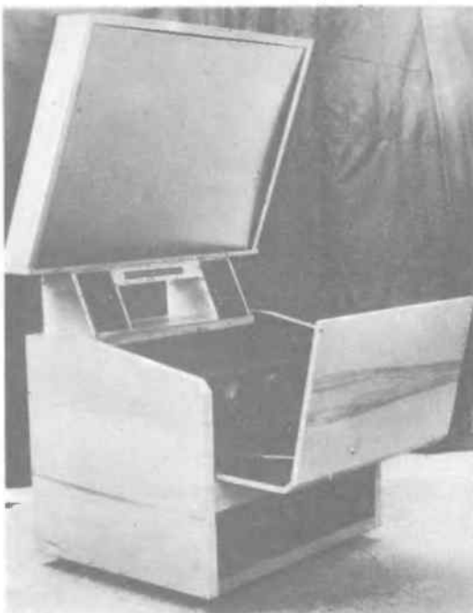
Рис. 2. Общий вид советского видеопроектора «Электроника ТВ 01 ПЦ» (диагональ встроенного отражающего экрана — 115 см) в развернутом для работы положении
