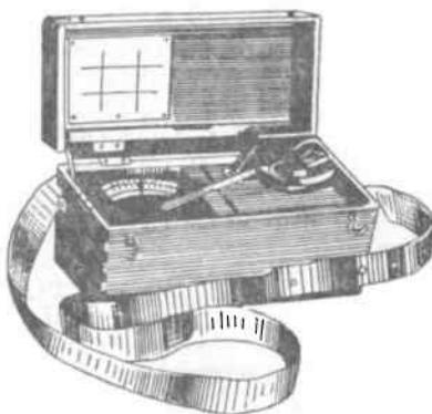
Рис. 1. Общий вид люксметра с выносным фотоэлементом
