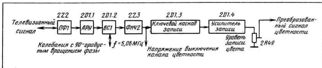
Рис. 2. Упрощенная структурная схема канала цветности в режиме записи сигналов цветности
