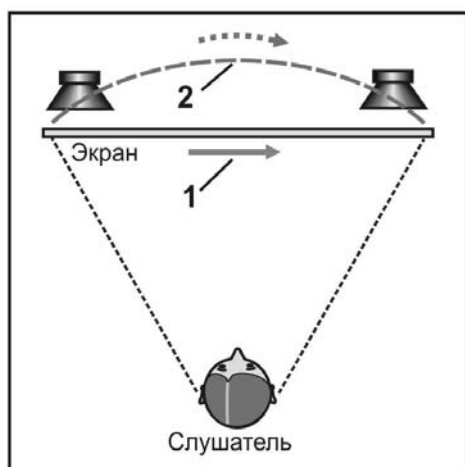
Рис.2. Схема действительного 1 и кажущегося 2 перемещения по экрану источника звука при двухканальном стереофоническом воспроизведении
