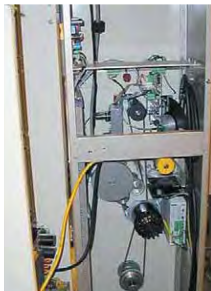
Головка кинопроектора с открытой крышкой
