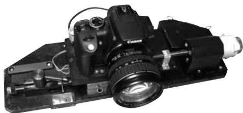
Цифровой фотоаппарат Canon EOS 350D на специальной базисной платформе для стереосъемки
