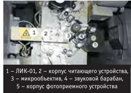
Рис.1. Лазерный излучатель ЛИК-01 в составе кинопроектора 23КПК
