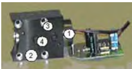
1 – лазерный модуль, 2 – держатель, 3 – посадочные места, 4 – стопорные винты
