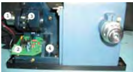
1 – лазерный модуль, 2 – стабилизатор напряжения, 3 – хомут, 4 – кронштейн
