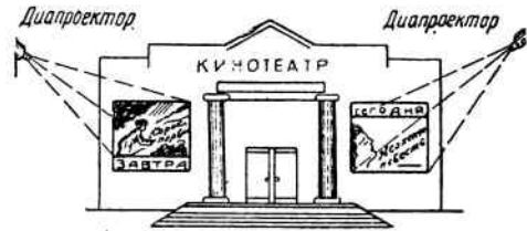
Рис. 3. Схема размещения диапроекторов и рекламных рисунков при оформлении фасада кинотеатра
