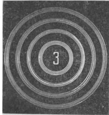
Рис. 3. Кольцевая мира испытательной таблицы
