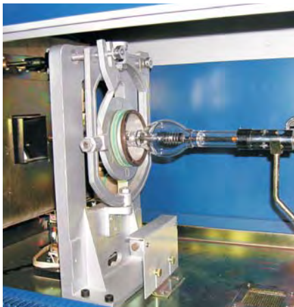
Отражатель не установлен
