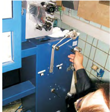
Переброс ролика для перевода фильма с тарелки на тарелку
