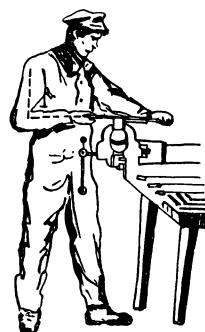
Рис. 3. Прием опиловки металла
