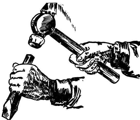
Рис. 2. Пример рубки
