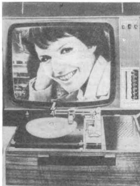
Рис. 6. Телевизионный проигрыватель фирмы «Телдек» (ФРГ) и телевизор. Цветная программа записана на видеопластинках
