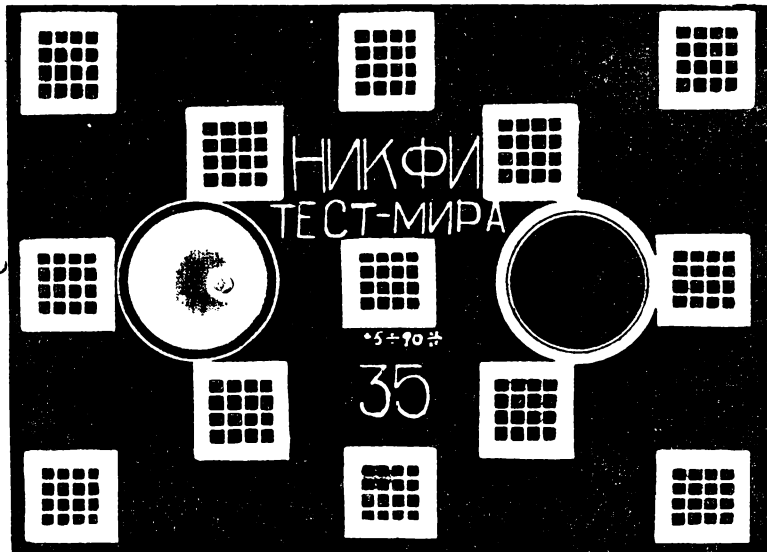
Рис. 4. Изображение тестмиры для проверки проекционных объективов
