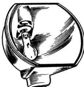
Рис. 5. Газоразрядная металлогалоидная лампа «Марк-300»
