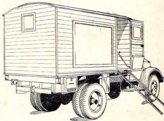
Рис. 11. Установка рельс для выгрузки и погрузки электростанции КЭС-5
