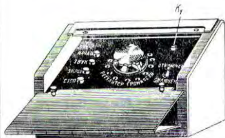
Рис. 3. Установка переключателя K-1 на панели пульта 6К-16 микшера
