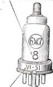
Рис. 7. Электронная лампа (индивидуальный номер лампы наносится кинемехаником)
