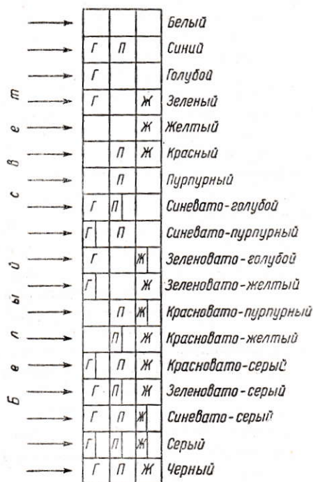
Рис. 6. Схема образования цветов при субтрактивном способе при совмещении желтого, пурпурного и голубого изображений
