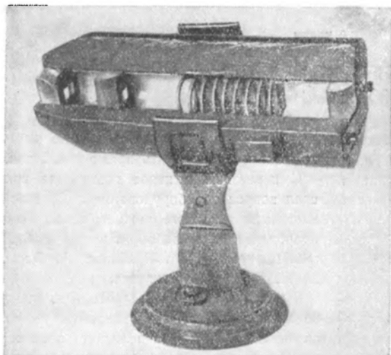
Рис. 4. Макет цилиндрической читающей оптики
