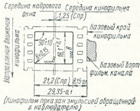
Рис. 2. Размеры и расположение кадрового окна кинопроектора для демонстрации широкоэкранных фильмов со стереофонической фонограммой (Норм-кино 44—58)
