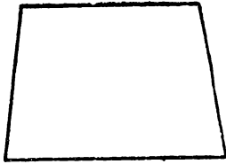
Рис. 5. Изображение кадрового окна кинопроектора на плоском экране при наличии вертикального угла проекции и отсутствии горизонтального угла проекции
