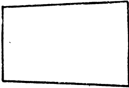
Рис. 6. Изображение кадрового окна кинопроектора на плоском экране при наличии горизонтального угла проекции и отсутствии вертикального угла проекции
