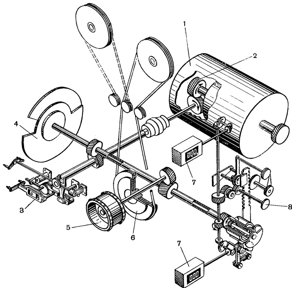
Рис. 78. Кинематическая схема аппарата СК-1:
