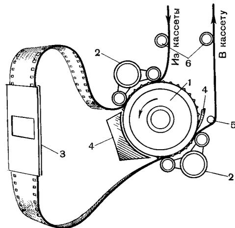
Рис. 97. Схема транспортирования пленок в аппарате ТКС-3:
