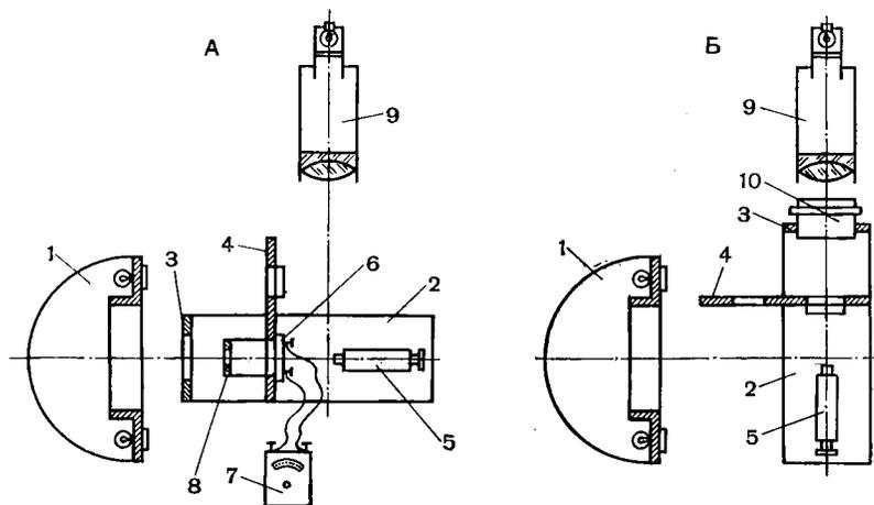
Рис. 148. Схема установки для измерения эффективного относительного отверстия объективов:
