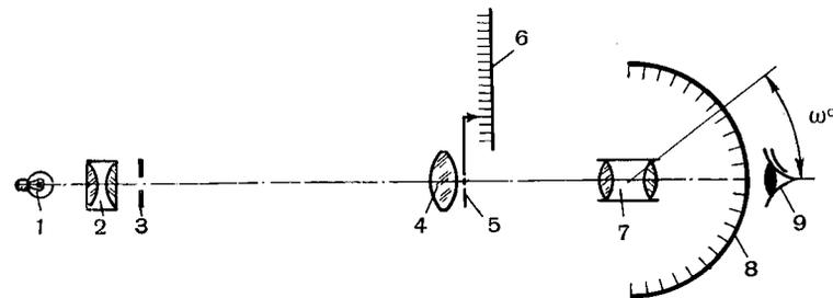
Рис. 149. Схема определения величины виньетирования:
