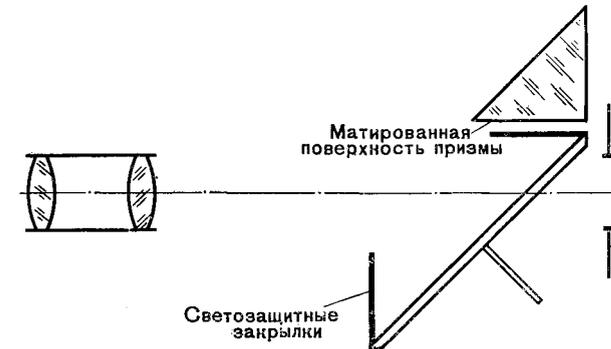
Рис. 28. Конические закрылки на лицевой стороне зеркального obtюратора
