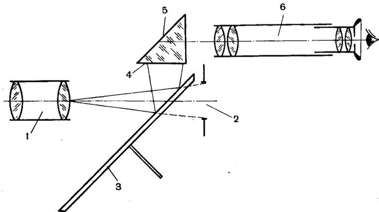
Рис. 41. Принципиальная схема визира с зеркальным обтюратором
