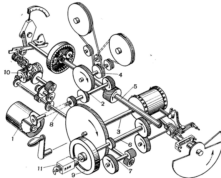
Рис. 88. Кинематическая схема аппарата 1-КСК
