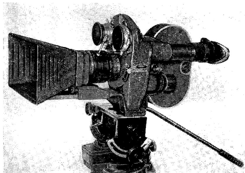
Рис. 55. Аппарат «Конвас-автомат» (модель 1-КСРШ) с анаморфтной насадкой
