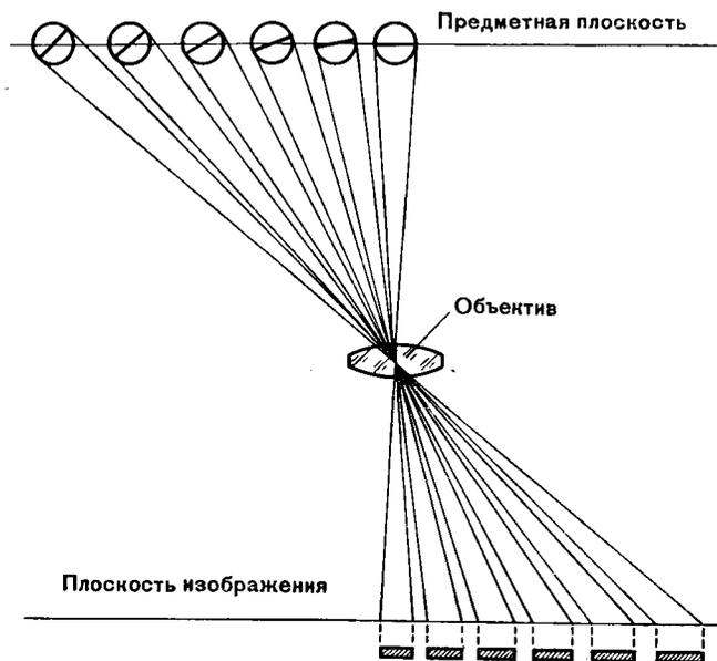
Рис. 52. Схема съемки широкоугольным объективом шаров одинакового диаметра, находящихся в одной плоскости
