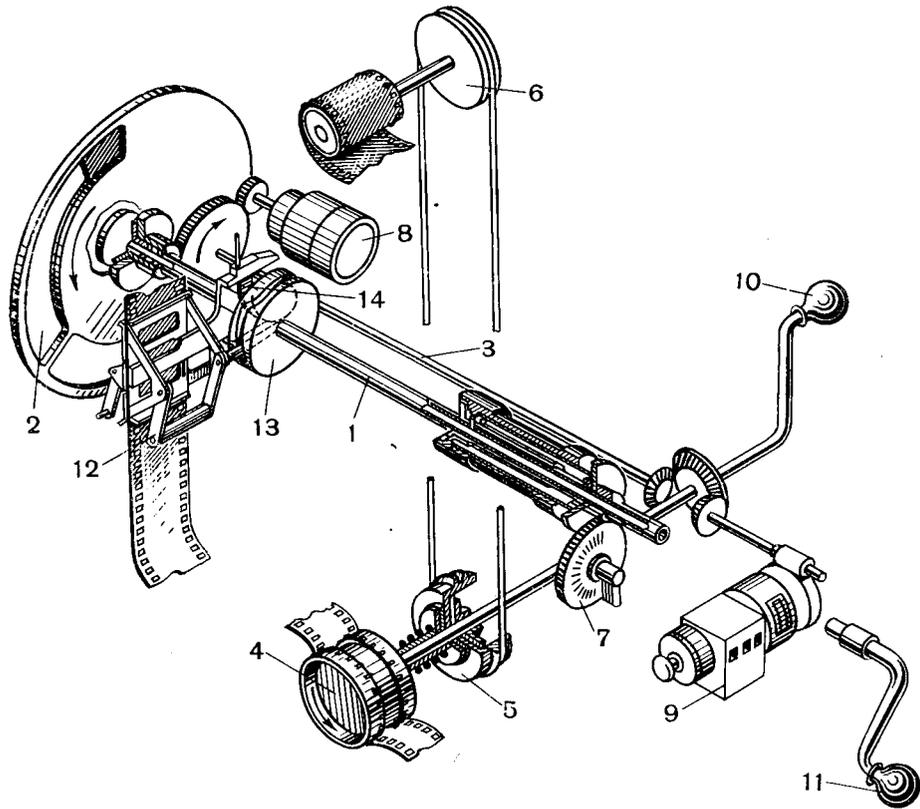
Рис. 92. Кинематическая схема аппарата ПСК-29:
