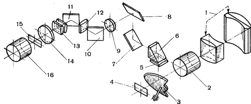
Рис. 64. Оптическая схема аппарата «Спутник» с анаморфотной съемочной насадкой и дезанаморфирующей лупой:
