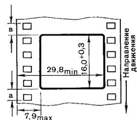
Рис. 15. Расположение негативного изображения на 35-мм киноплёнке
