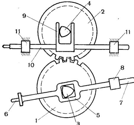
Рис. 13. Грейферный механизм кулачкового типа с контргрейфером
