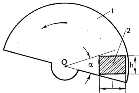
Рис. 23. Схема дискового обтюратора
