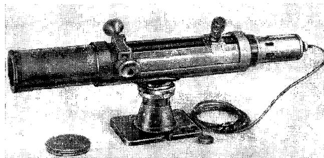
Рис. 142. Автоколлиматор с объективом 520 мм
