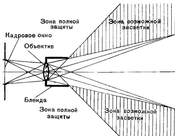
Рис. 36. Сокращение зоны засветки светозащитным устройством
