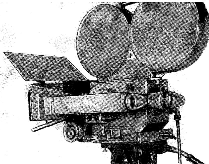
Рис. 110. Киносъемочный широкоформатный аппарат 70-КСК
