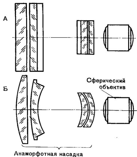
Рис. 51. Схема цилиндрической анаморфотной съемочной насадки
