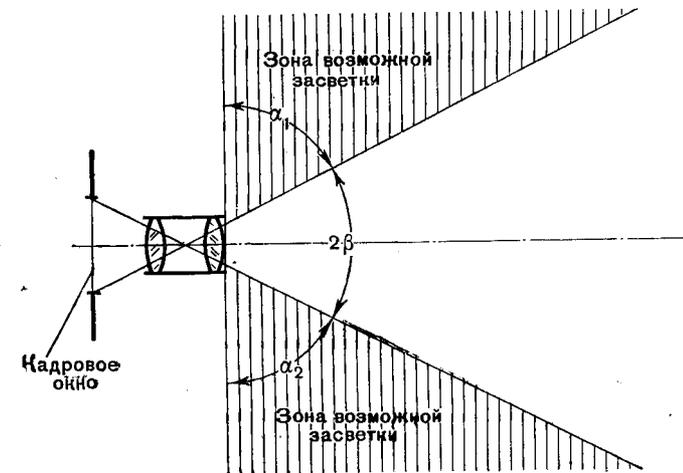
Рис. 35. Зона возможной засветки у объектива без светозащитного устройства
