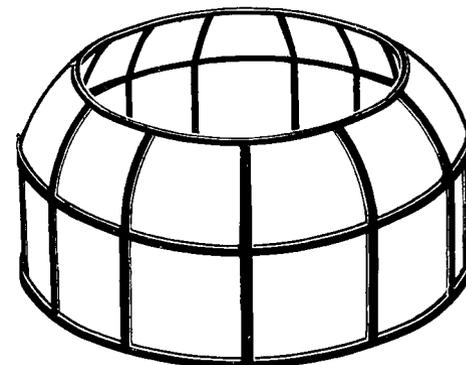
Рис. 128. Схема расположения экранов в двухъярусном театре круговой кинопанорамы с 22 проекторами
