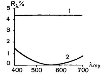
Рис. 44. Зависимость коэффициента отражения от длины волны света для непросветленной (1) и просветленной (2) поверхностей стекла
