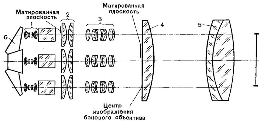
Рис. 121. Схема визирующего устройства аппарата «Панорама»: 1 — объективы визира, 2 — двухлинзовый коллектив, 3 — промежуточные постоянные объективы, 4 — общая коллективная линза, 5 — окуляр, 6 — призматическая насадка, общая для объективов визира и съемочных
