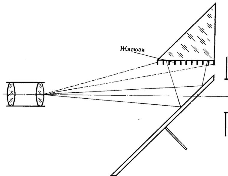
Рис. 29. Жалюзи в системе визирования с зеркальным obtюратором
