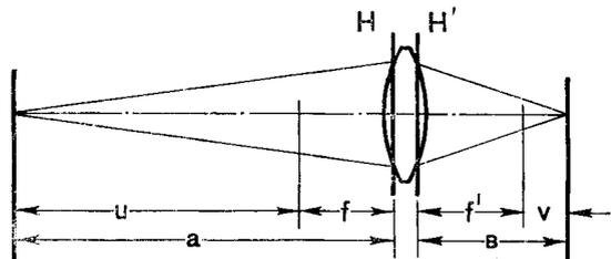
Рис. 31. Схема построения объективом изображения точки
