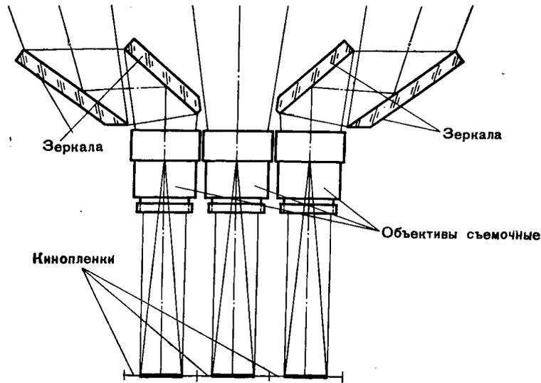
Рис. 120. Схема блока с зеркальной насадкой и объективами 100 мм для аппарата «Панорама»
