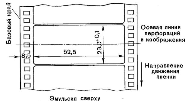
Рис. 18. Размеры и расположение негативного изображения широкоформатного фильма на 70-мм киноплёнке
