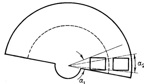
Рис. 24. Зависимость угла предварительного закрытия и диаметра обтюратора от расположения кадрового окна относительно центра вращения
