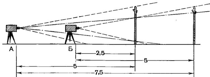
Рис. 45. Схема выполнения «наезда»
