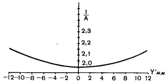
Рис. 156. График изменения коэффициента анаморфирования по полю кадра
