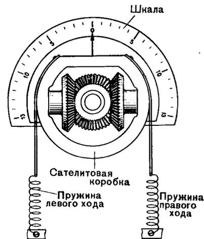
Рис. 135. Конструктивная схема ротационного динамометра
