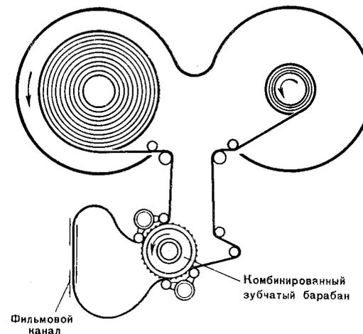
Рис. 2. Схема прохождения пленки в киносъёмочном аппарате с одним зубчатым барабаном
