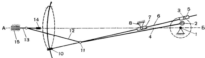
Рис. 11. Кинематическая схема грейферного механизма аппарата «Родина»
