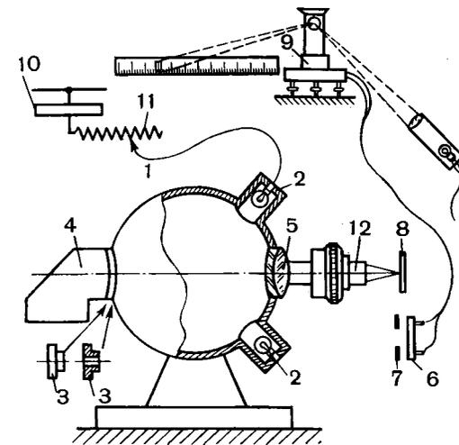
Рис. 146. Схема установки для измерения коэффициента светорассеяния
