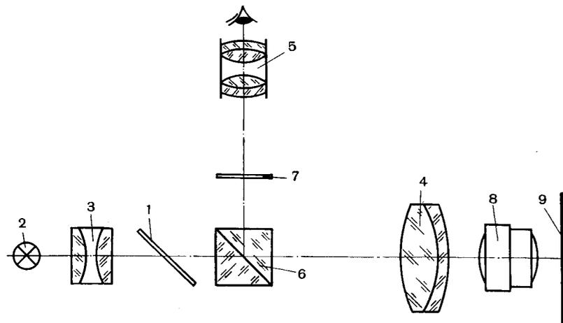
Рис. 139. Схема автоколлиматора с наклонной мирой для проверки и градуировки дистанционных шкал кино съемочных объективов
