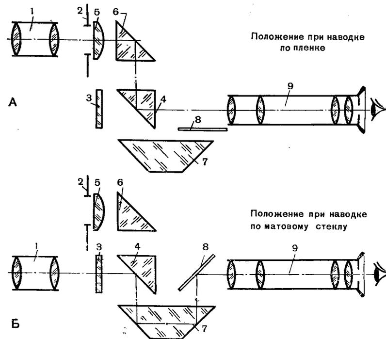
Рис. 89. Схема системы сквозной наводки аппарата 1-КСК:
