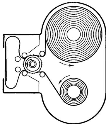
Рис. 22. Схема хода пленки в приставной кассете ручного аппарата
