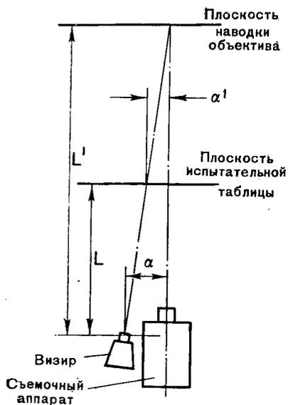
Рис. 144. Схема проверки при- ставных визиров на дистан- циях больше 5 м
