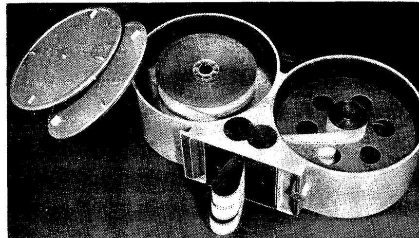
Рис. 122. Кассета киносъемочного аппарата «Панорама»
