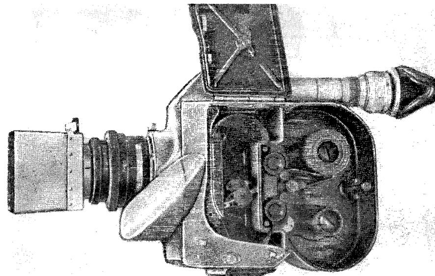
Рис. 103. Ход плёнки в аппарате 1-КСШР
