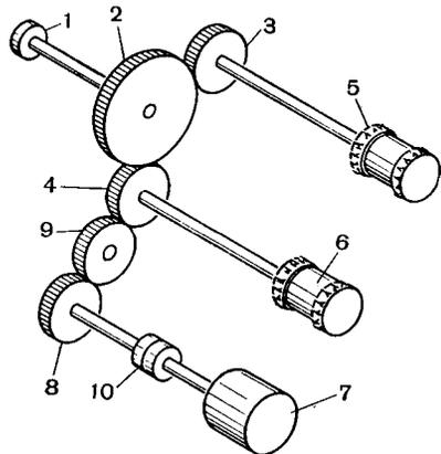
Рис. 104. Кинематическая схема механизма, расположенного в кассете
