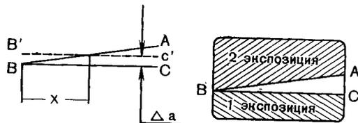
Рис. 131. Схема действия устройства для проверки устойчивости изображения
