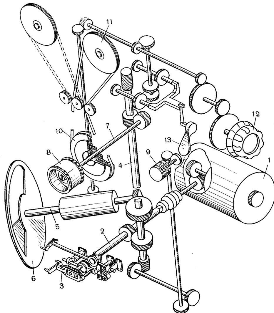
Рис. 67. Кинематическая схема аппарата «Дружба»:
