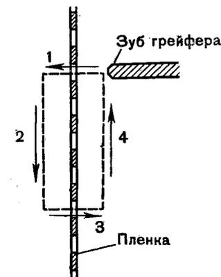
Рис. 6. Идеализованная траектория движения зуба грейфера
