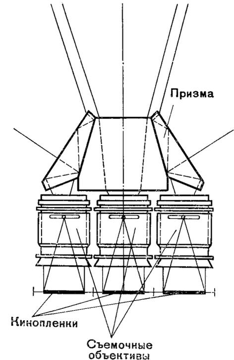
Рис. 119. Схема блока объективов с фокусными расстояниями 35 мм для аппарата «Панорама»
