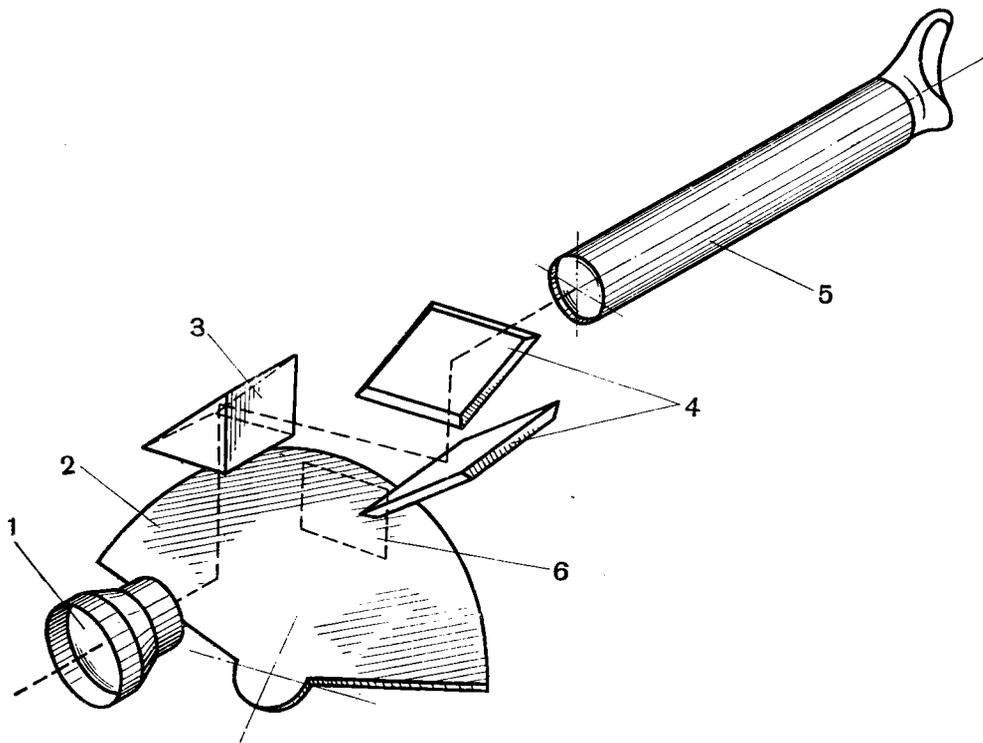
Рис. 58. Оптическая схема аппарата «Конвас-автомат»: 1 — съемочный объектив, 2 — зеркальный обьектор, 3 — прямоугольная призма, 4 — зеркала, 5 — лупа, 6 — кадровое окно
