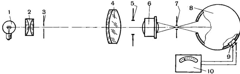
Рис. 147. Схема установки для измерения коэффициента светопропускания
