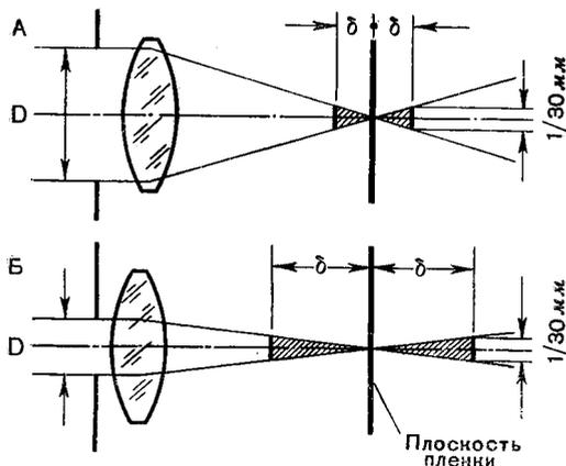
Рис. 32. Зависимость допустимого смещения плоскости пленки от величины действующего отверстия объектива
