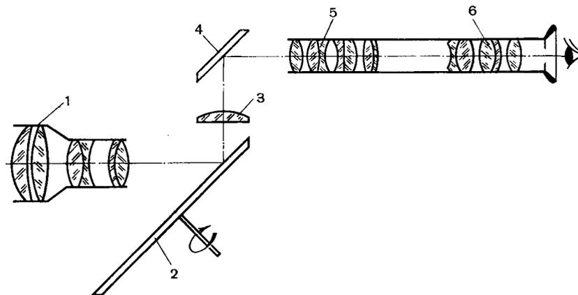
Рис. 84. Оптическая схема аппарата «Родина»:
