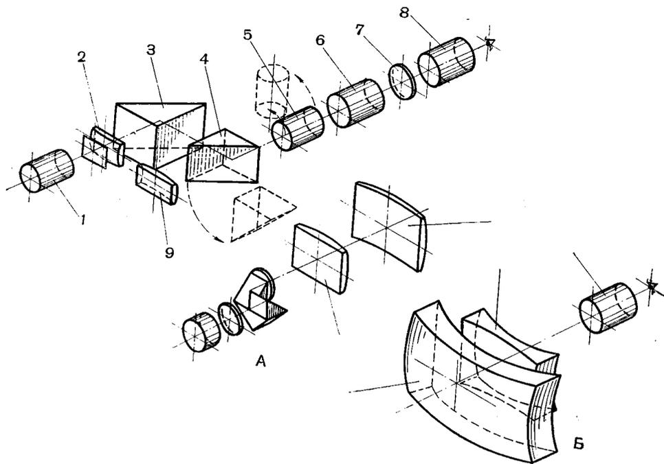
Рис. 114. Оптическая схема системы сквозной наводки и приставных визиров киносъёмочного аппарата 70-КСК:
