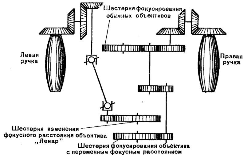
Рис. 63. Схема управления съемочными объективами аппарата «Спутник»
