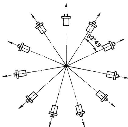
Рис. 126. Схема расположения аппаратов в установке для съемки по методу круговой кинопанорамы
