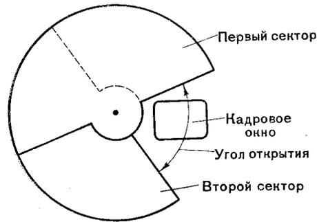
Рис. 25. Схема обтюратора с переменным углом открытия
