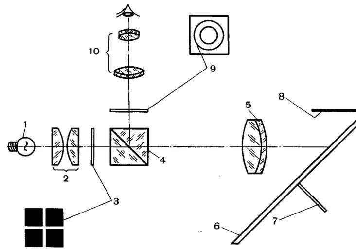
Рис. 138. Схема проверки биения зеркального обтюратора:
