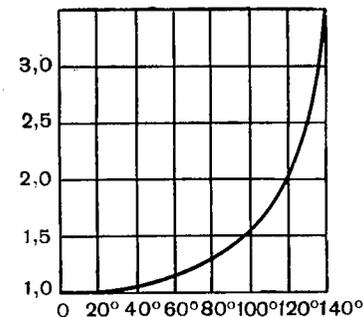
Рис. 53. Зависимость искажения формы изображений предметов от угла поля изображения съемочного объектива
