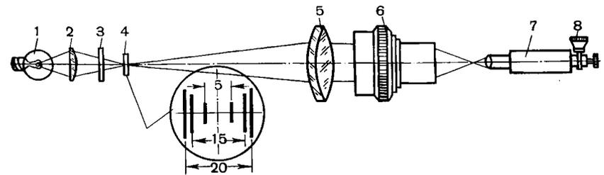
Рис. 145. Схема установки для измерения фокусного расстояния объективов: 1 — источник света, 2 — конденсор, 3 — матовое стекло, 4 — штриховая шкала, 5 — коллиматор, 6 — испытуемый объектив, 7 — микроскоп, 8 — окулярный микрометр
