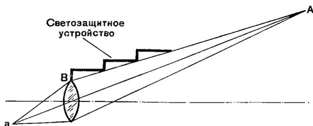
Рис. 37. Правильное построение светозащитного устройства
