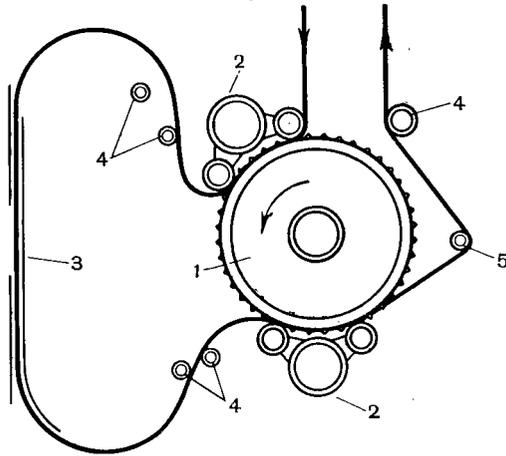
Рис. 107. Схема прохождения пленки в аппарате 70-СК:
