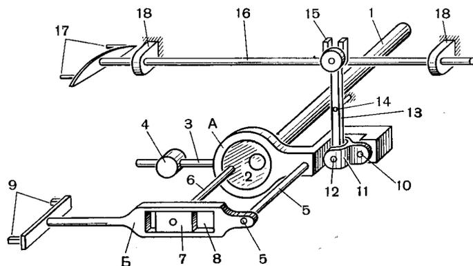
Рис. 9. Конструктивная схема грейферного механизма кривошипно-шатунного типа с качающейся кулисой и контргрейфером
