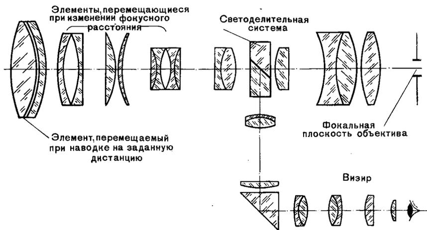
Рис. 48. Схема объектива типа «Ленар-2» с визирующим устройством
