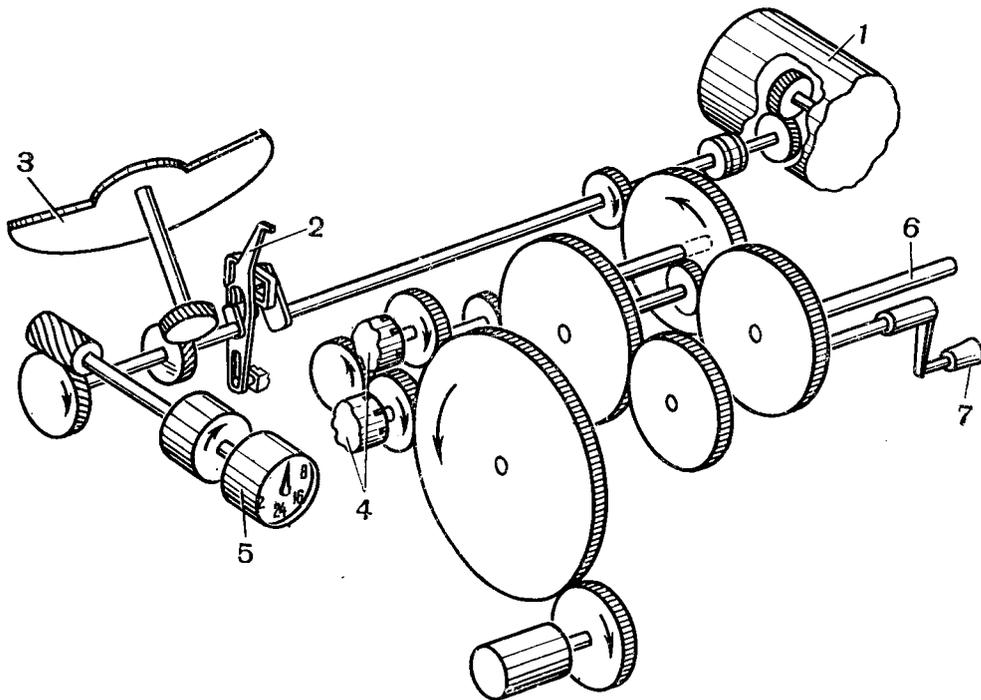
Рис. 57. Кинематическая схема аппарата «Копвас-автомат»:
