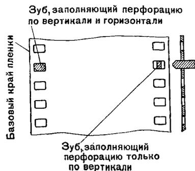
Рис. 8. Фиксация положения пленки зубьями контргрейфера
