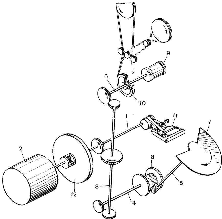
Рис. 74. Кинематическая схема аппарата «Эра»:
