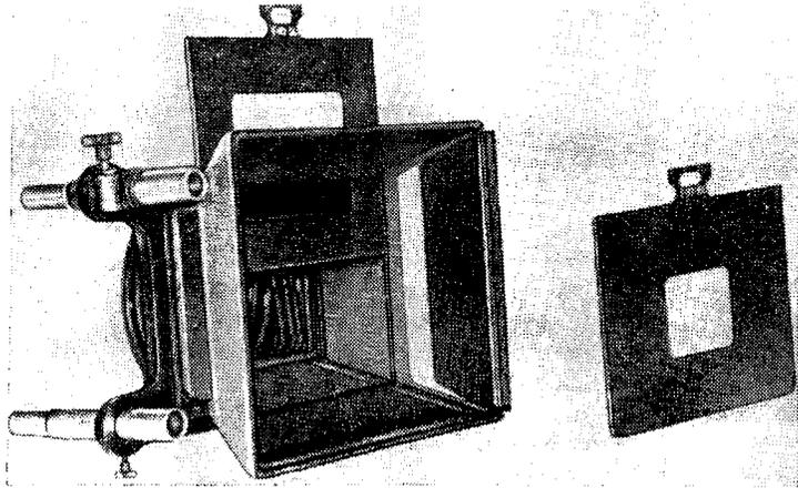
Рис. 38. Светозащитное устройство прямоугольной формы со сменными кашетами и раздвижным мехом
