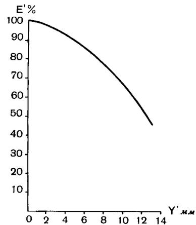
Рис. 152. График распределения освещенности по полю кадра
