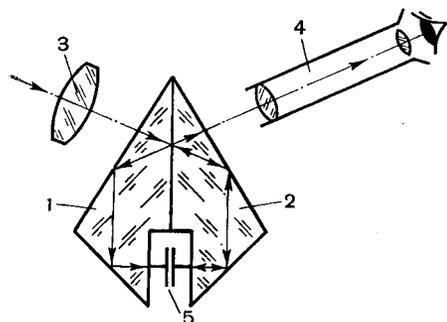
Рис. 95. Принципиальная схема светоделительного устройства аппарата ТКС-3: 1—первый элемент светоделительного блока, 2—второй элемент светоделительного блока, 3—съёмочный объектив, 4—лупа, 5—пленки, проходящие в फिल्मовом канале
