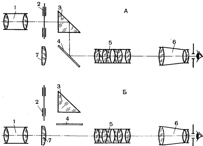
Рис. 93. Оптическая схема аппарата ПСК-29
