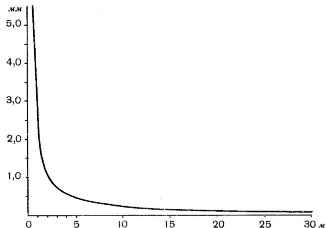
Рис. 34. Зависимость величины дополнительного выдвижения объектива от дистанции наводки
