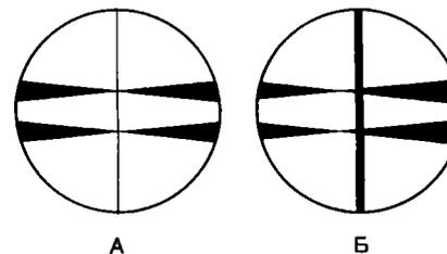
Рис. 141. Изображение наклонной миры в окуляре коллиматора
