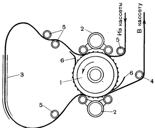
Рис. 86. Схема хода пленки в аппарате 1-КСК:
