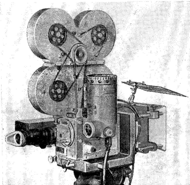
Рис. 87. Аппарат 1-КСК перемещается относительно угольника с объективодержателем и светозащитным устройством
