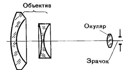
Рис. 42. Схема телескопического визира
