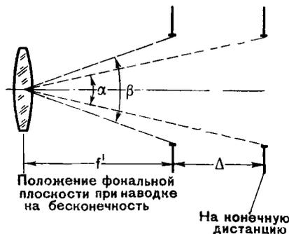
Рис. 43. Изменение величины угла изображения при различных дистанциях наводки:
