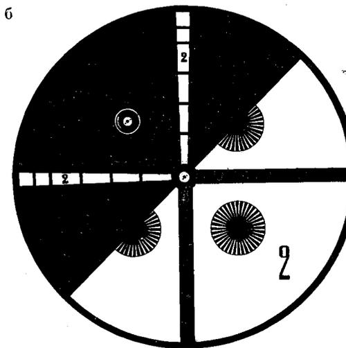
Рис. 132. Испытательная таблица для проверки устойчивости изображения
