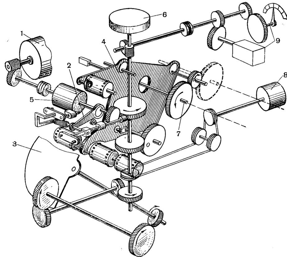
Рис. 83. Кинематическая схема аппарата «Родина»: 1 — электродвигатель, 2 — грейферный механизм, 3 — зеркальный обтуратор, 4 — кулиса, 5 — маховик на оси грейферного механизма, 6 — маховик на вертикальном валу, 7 — ось фрикциона кассеты, 8 — тахометр, 9 — счетчики
