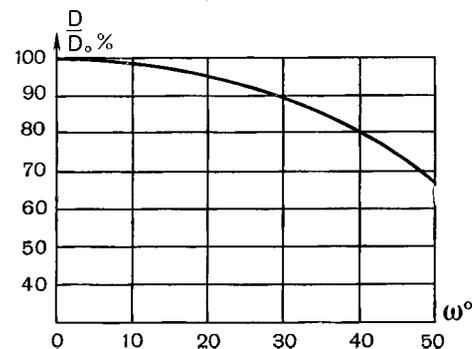
Рис. 150. График результатов измерения величины виньетирования
