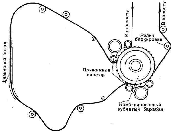
Рис. 69. Схема транспортирования пленки в аппарате «Мир»
