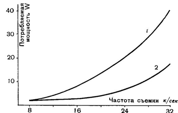
Рис. 30. Зависимость потребляемой аппаратом «Ковнас-автомат» мощности от частоты съемки
