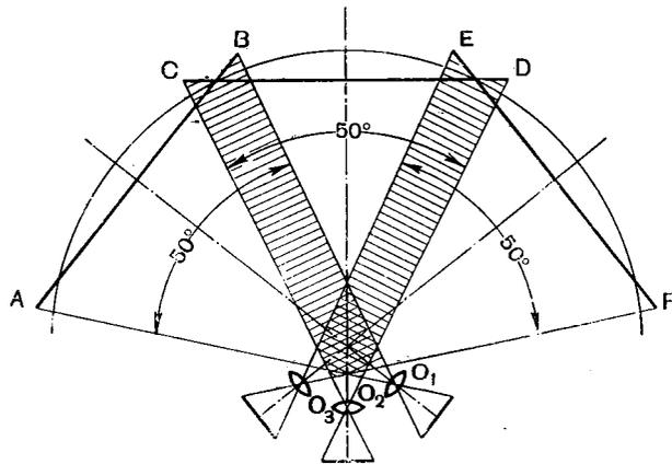
Рис. 125. Оптическая схема съемки панорамным аппаратом СКП-1:
