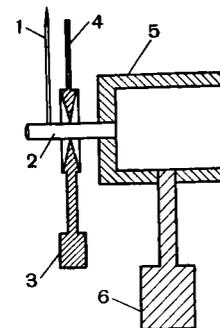
Рис. 137. Схематический разрез динамометра маятникового типа
