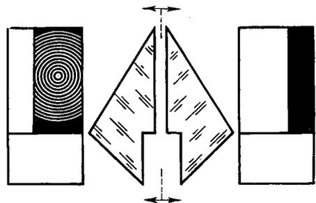
Рис. 96. Схема зеркального растра на левой половине светоделительного блока и сплошного зеркального слоя — на правой
