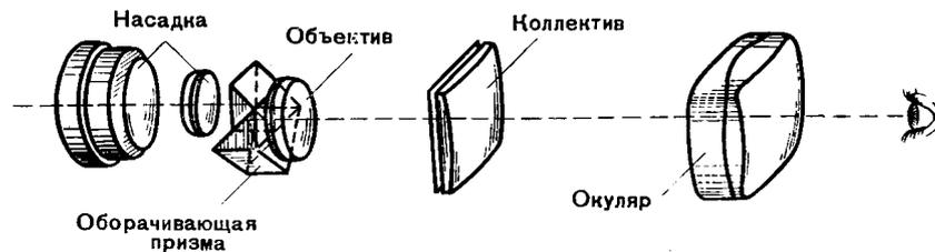
Рис. 71. Оптическая схема визира кипосъемочного аппарата «Мир»
