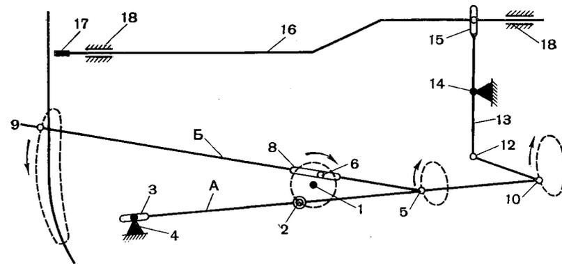
Рис. 10. Кинематическая схема грейферного механизма кривошипно-шатунного типа с качающейся кулисой и контргрейфером
