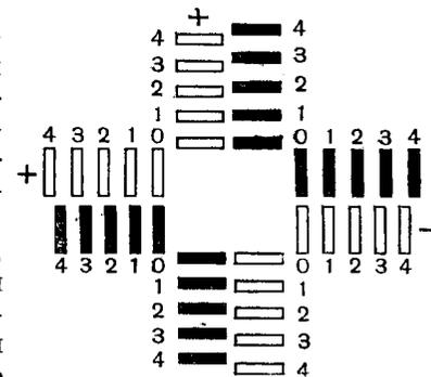
Рис. 130. Схема расположения основных и нониусных шкал для проверки устойчивости изображения
