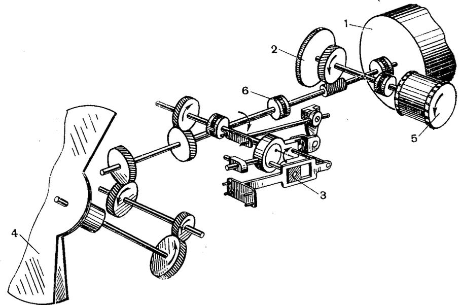
Рис. 70. Кинематическая схема аппарата «Мир»: 1 — электродвигатель, 2 — передача на ось зубчатого барабана, 3 — грейферный механизм, 4 — обтюратор, 5 — зубчатый барабан, 6 — муфта, соединяющая две части главного вала
