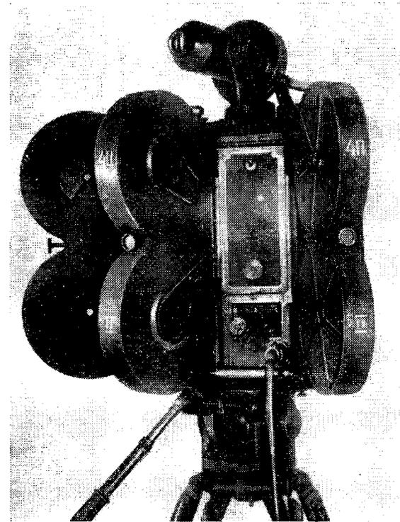
Рис. 124. Панорамный киносъемочный аппарат СКП-1
