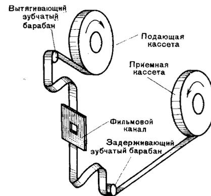
Рис. 4. Схема хода пленки в аппарате с трехплоскостным транспортированием и двумя зубчатыми барабанами
