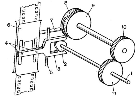
Рис. 14. Грейферный механизм кулачкового типа с пульсирующим фильмовым каналом
