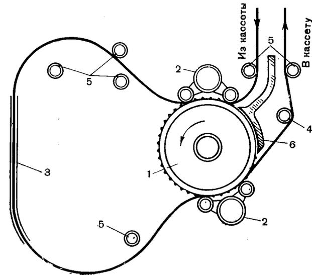
Рис. 111. Схема хода пленки в аппарате 70-КСК:
