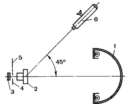
Рис. 151. Схема установки для измерения распределения освещенности по полю кадра:
