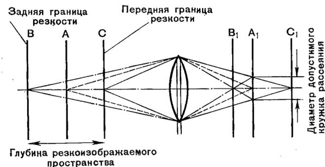
Рис. 33. Глубина резко изображаемого пространства
