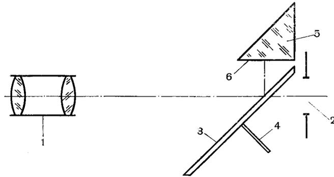
Рис. 26. Схема расположения зеркального obtюратора: 1 — объектив, 2 — кадрое окно, 3 — зеркальная поверхность obtюратора, 4 — ось вращения obtюратора, 5 — призма, 6 — матованная поверхность
