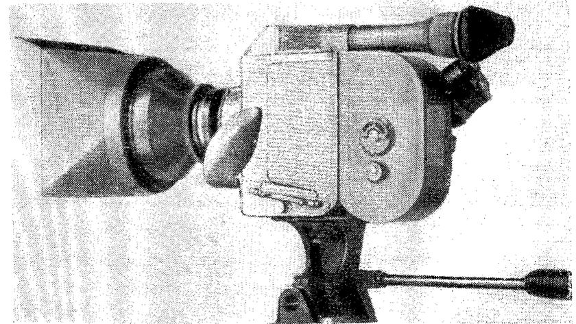
Рис. 102. Ручной широкоформатный киносъемочный аппарат 1-КСШР
