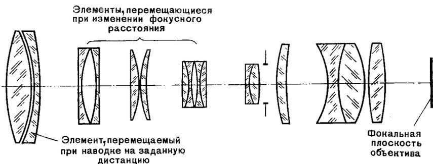
Рис. 47. Схема объектива типа «Ленар-1» с переменным фокусным расстоянием
