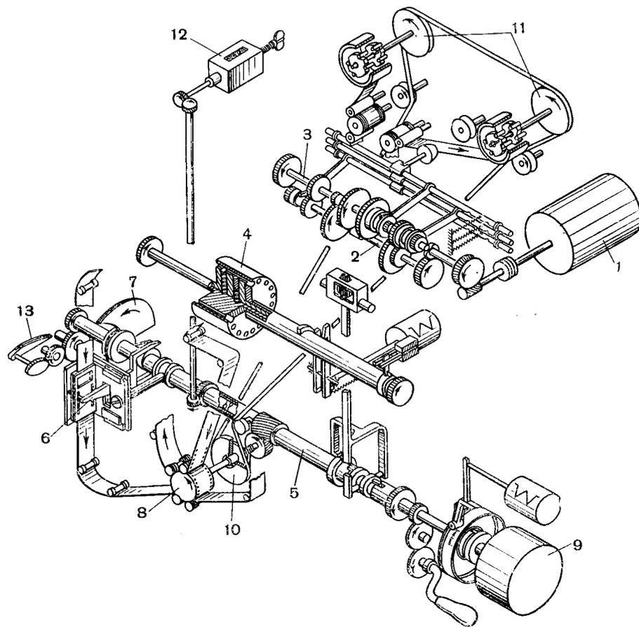
Рис. 101. Кинематическая схема аппарата 1-КСМ:
