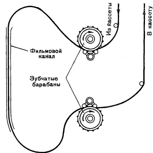
Рис. 3. Схема хода пленки в аппарате с двумя зубчатыми барабанами
