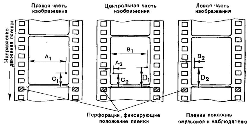
Рис. 115. Расположение изображений в негативе на трех пленках в панорамной системе кинематографа
