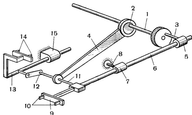
Рис. 12. Конструктивная схема грейферного механизма аппарата «Родина»
