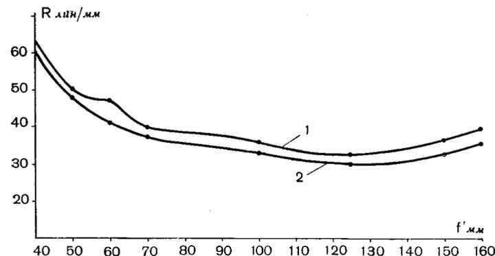
Рис. 46. Разрешающая сила объектива «Ленар-2» при относительном отверстии 1:3,8 в центре поля для различных значений фокусного расстояния
