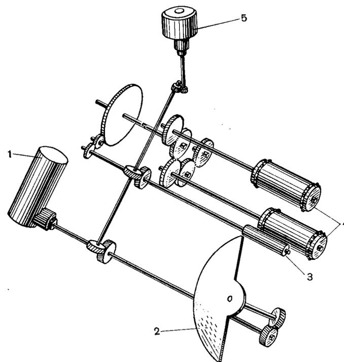
Рис. 105. Кинематическая схема киносъемочного аппарата 1-КСШР:
