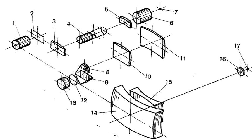
Рис. 109. Оптическая схема лупы и приставных визиров аппарата 70-СК: 1 — съёмочный объектив, 2 — кадровое окно, 3 — коллектив с матованной поверхностью, 4 — объектив лупы, 5 — коллективная линза, 6 — окуляр лупы, 7 — зрачок лупы, 8 — объектив проекционного визира, 9 — оборачивающая система, 10 — коллектив с матованной поверхностью, 11 — окуляр визира, 12 — защитное стекло, 13 — насадка, 14 и 15 — отрицательные линзы телескопического визира, 16 — положительная линза, 17 — выходной зрачок
