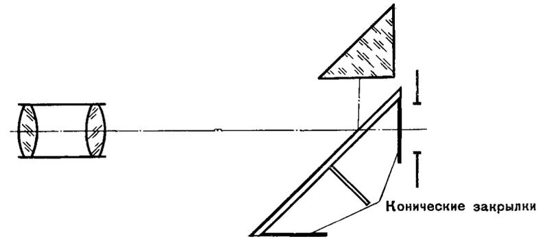
Рис. 27. Расположение конических закрылок на обратной стороне зеркального obtюратора
