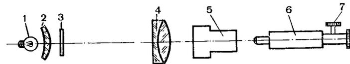
Рис. 155. Схема установки для измерения коэффициента анаморфирования:
