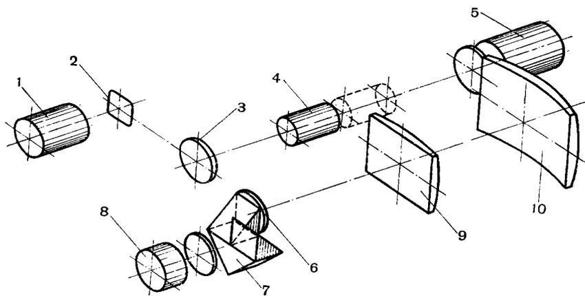
Рис. 79. Оптическая схема лупы и приставного визира аппарата СК-1:
