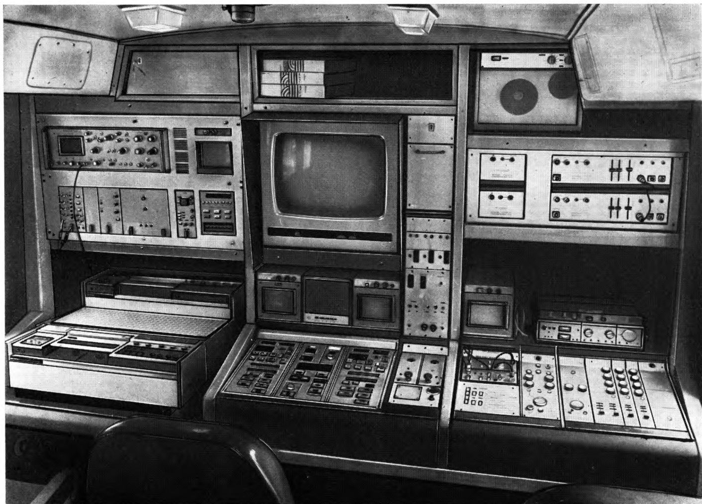
Рабочий салон комплекса 1КПК. Пульты: звукооператора, видеоинженера и монтажа видеолент 1КПК set. Working compartment. Sound control, video control, and videotape editor's panels
