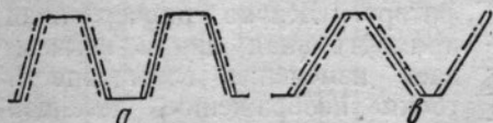
Рис. 40. Кривая изменения освещенности точки кадра при obtюраторе между объективом и фильмовым каналом при объективе с малым относительным отверстием (а) и объективе с большим относительным отверстием (б)
