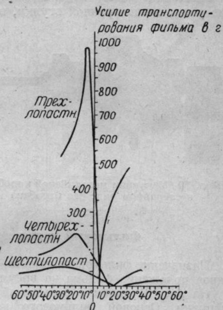
Рис. 28. Кривые полных усилий транспортирования фильма для разных мальтийских крестов
