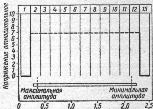
Рис. 53. Идеальная диаграмма равномерности освещения щели
