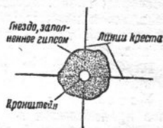
Рис. 43. Схема установки кронштей- на усилительного шкафа
